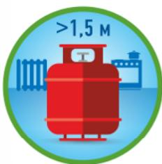
Размещайте баллон на расстояние более 1,5 м от плиты, радиатора отопления или печи
