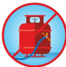
Не располагайте баллон рядом с оголенными электрическими проводами
